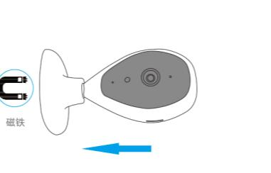
将铁片固定在墙上，设备直接吸附在铁片上，底座就安装完成
