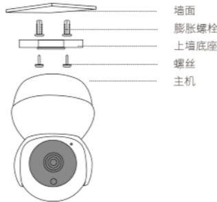
用螺丝把底座固定在平整的墙面，将设备机身旋转固定在上墙底座上，底座安装就完成了。
